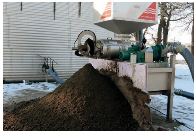
PSS 4-550 separiert mit ausgefahren Stützen und entlastet das Güllelager. PSS 4-550 separates with extended pillars and releases the manure storage.
