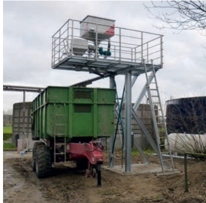
Dieser PSS 2.2-400 mit Vortagebehälter steht auf einem Schweinemastbetrieb mit ca. 5 % TS in der Ausgangsgülle. Der Kipphanhänger ist nach ca. 1,5 Tagen mit dem Separationsmaterial gefüllt. This PSS 2.2-400 with hopper runs on a pig production farm with a dry matter content of about 5% in the raw material. The tipping trailer is filled within 1,5 days.
