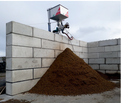
Rohgülle von ca. 6,5 % TS wird auf ca. 20 % TS Gehalt abgepresst und schafft ca. 7 m³ pro Stunde. Raw material with 6,5 % dry matter is pressed to 20 % dry matter and reaches a throughput of 7 m³.
