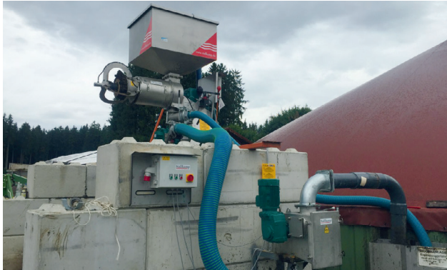
PSS 5.5-550 Mobile Einheit Small separiert Gärreste. PSS 5.5-550 small mobile unit separates digestate.
