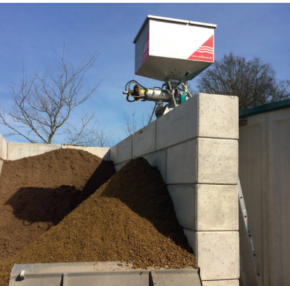
Rohgülle von ca. 6,5 % TS wird auf ca. 20 % TS Gehalt abgepresst und schafft ca. 7 m³ pro Stunde. Raw material with 6,5 % dry matter is pressed to 20 % dry matter and reaches a throughput of 7 m³.
