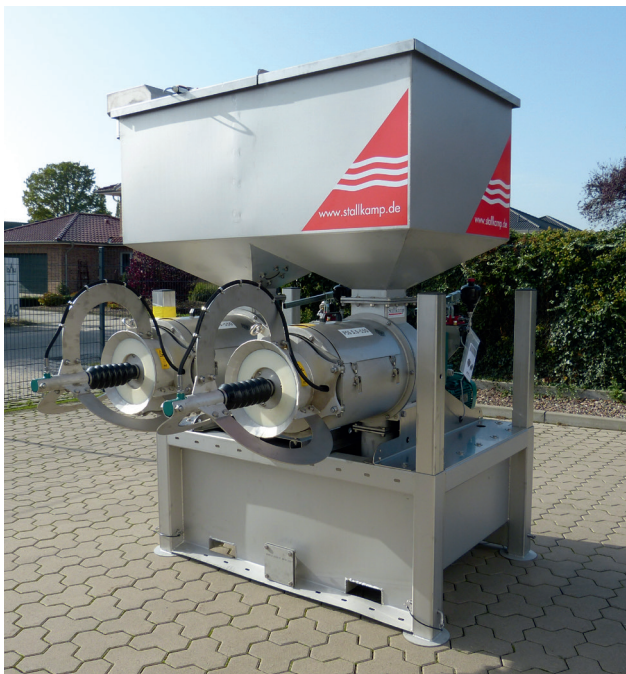
Zwei Separatoren PSS 5.5-550 als Mobile Einheit Large Double für hohe Durchsatzleistung. | Two separators PSS 5.5-550 as one mobile unit double for high throughput.
