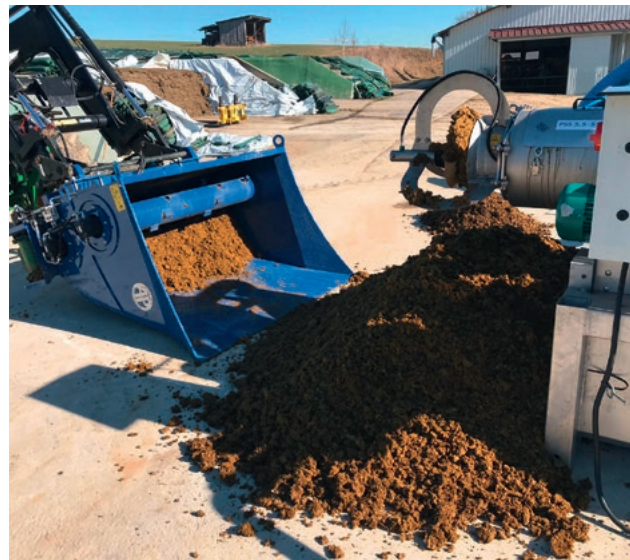
PSS 5.5-550 производит подстилку с содержанием СВ более 30%. PSS 5.5-550 wyciska separat o zawartości suchej masy powyżej 30% do ścielenia legowisk.
