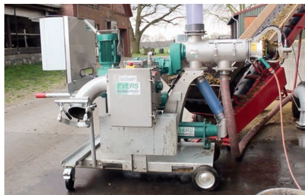
ComPress со встроенным фильтр-измельчителем для защиты насоса, производит подстилку для коров. | Do produkcji ściółki na legowiska ComPress ze zintegrowanym filtrem odcinającym, chroniącym pompę i inne komponenty.
