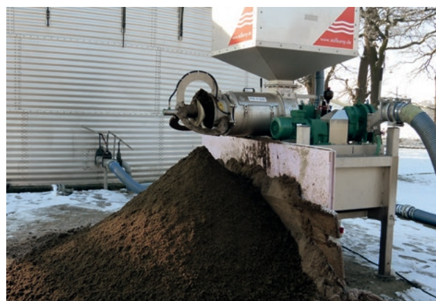
PSS 4-550 установлен на опорах и сепарирует навоз. | PSS 4-550 ustawiony na maksymalnie wysuniętych podporach separuje gnojowicę zmniejszając pojemność magazynowania.
