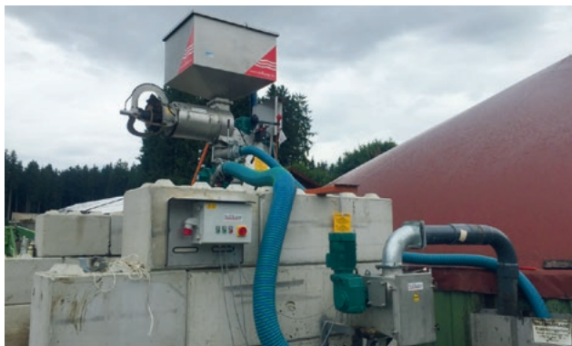
PSS 5.5-550 Мобильный блок Small сепарирует дигестат Jednostka mobilna Small z PSS 5.5-550 separuje masę pofermentacyjną.
