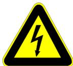
In der Montage, Betriebs- und Wartungsanleitung sind Warnungen vor elektrischer Spannung mit dem Sicherheitszeichen nach DIN 4844-W8 gekennzeichnet.
