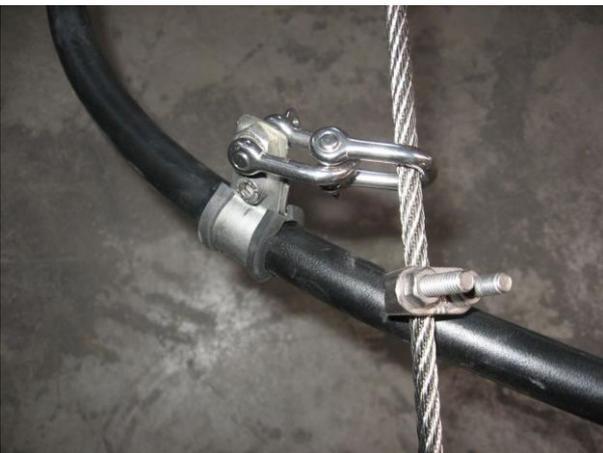
**Bild 4: Seilklemme und 1. Kabelschelle**
