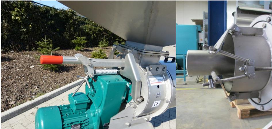
Ouvrez les trappes d'évacuation à l'aide du levier tendeur et remplissez la cavité de l'orifice.
