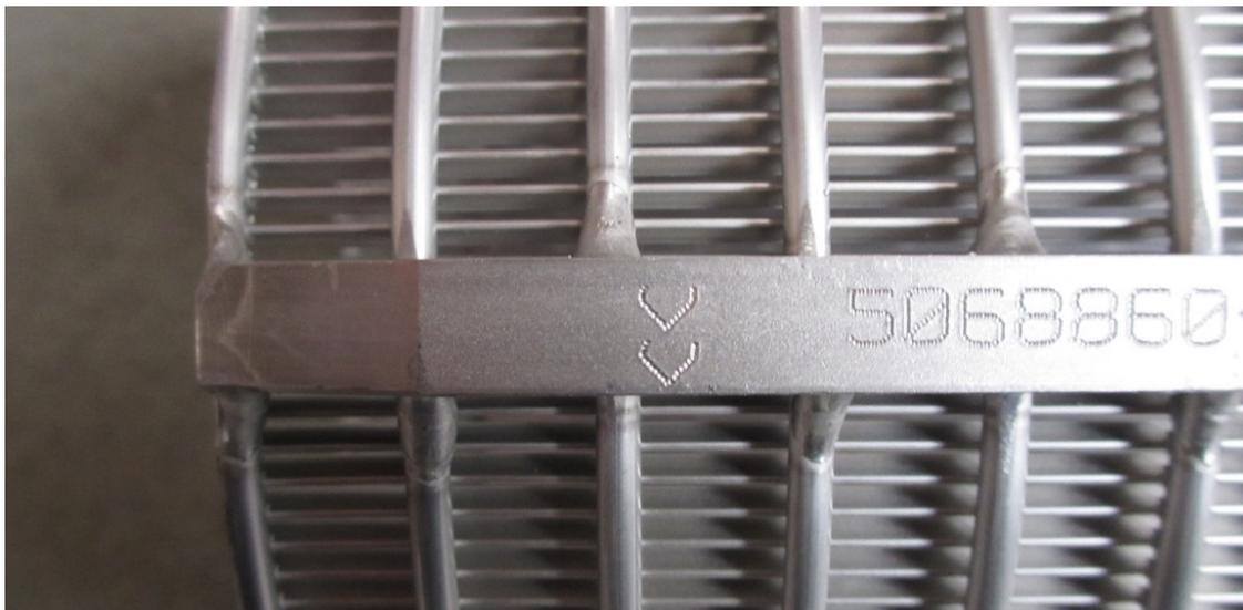
11. Repositionnez la bague d'écartement et fermez la trappe. Ce faisant, veillez à ce que le tamis ne soit pas sous tension (**voir 10.5 Régler le jeu axial du tamis**)
