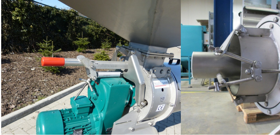
Auswurfklappen mittels Spannhelbcl öffnen und den Hohlraum im Auswurf füllen.
