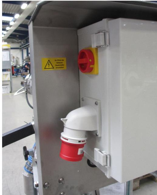
Installez le séparateur de façon à ce que le boîtier de commande soit à l'abri de l'humidité et de l'ensoleillement direct.
