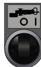
**Sélecteur de mode AUTO/manuel :** la commande du séparateur peut être commutée entre le mode AUTO et le mode manuel. En mode AUTO, seul le bouton double de séparation peut être exploité. En mode manuel, seule la pompe rotative à palettes et l'interrupteur de séparation peuvent être exploités. En mode manuel, ces deux interrupteurs sont actifs uniquement lorsqu'ils sont tous les deux positionnés sur « 0 ».
