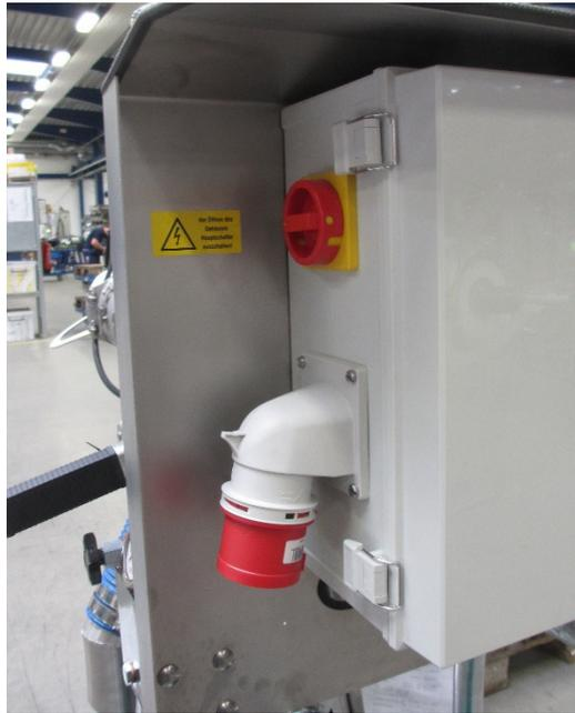
Stellen Sie den Separator so auf, dass der Schaltkasten vor Feuchtigkeit und direkten Sonnenstrahlen geschützt ist.
