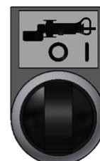
**Wahlschalter Betrieb Auto/Hand:** Die Steuerung des Separators kann zwischen Auto-Betrieb und Hand-Betrieb umgeschaltet werden. Im Auto-Betrieb kann nur der Separation Doppeltaster bedient werden. Im Hand-Betrieb nur der Drehkolbenpumpe und Separator Schalter. Im Hand-Betrieb werden die beiden Schalter erst aktiv wenn diese auf „0“ stehen.
