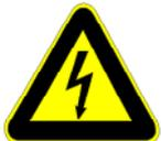
In der Betriebsanleitung sind Warnungen vor elektrischer Spannung mit dem Sicherheitszeichen nach DIN 4844-W8 gekennzeichnet.
