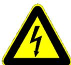
Les mises en garde sur la tension électrique sont signalées dans le mode d'emploi à l'aide d'un symbole de danger suivant la norme DIN 4844-W8.
