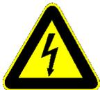
In der Betriebsanleitung sind Warnungen vor elektrischer Spannung mit dem Sicherheitszeichen nach DIN 4844-W8 gekennzeichnet.
