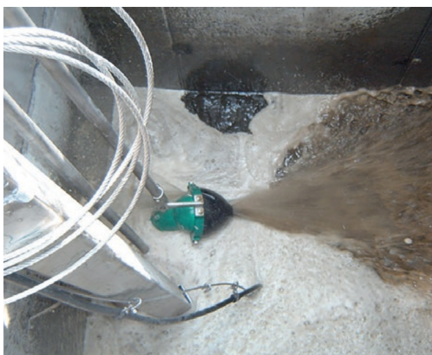
Buse de mélange en fonctionnement Ugello miscelatore in funzione
