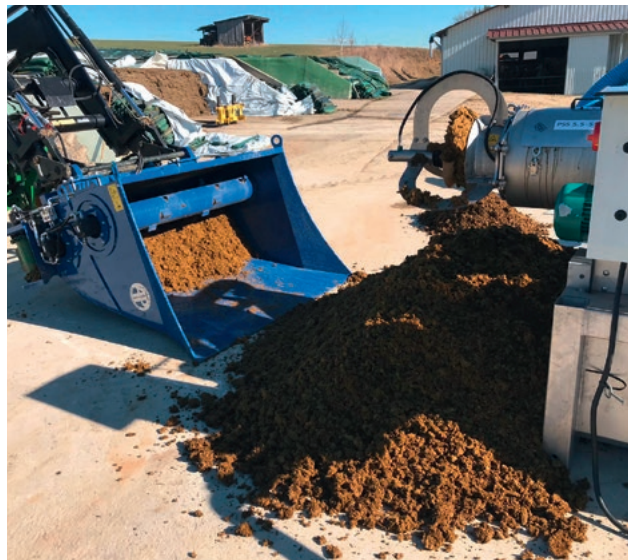
PSS 5.5-550 produit des substances solides avec plus de 30 % de matière sèche comme litière. | PSS 5.5-550 produce solidi con oltre il 30% di contenuto di sostanza secca per lettiera.
