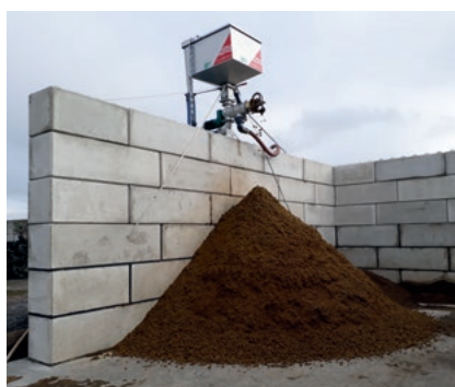
Lisier brut avec env. 6,5 % de matière sèche pressé à 20 % de matière sèche pour un débit d'env. 7 m 3 par heure.
