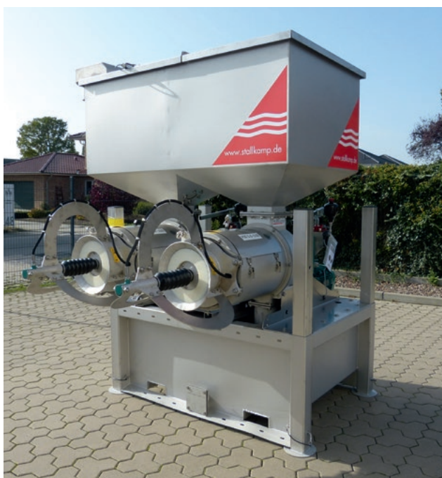
Deux séparateurs PSS 5.5-550 en une double unité mobile « Large » pour un débit élevé. | Due separatori PSS 5.5-550 come unità mobile Large Double per un'elevata portata.
