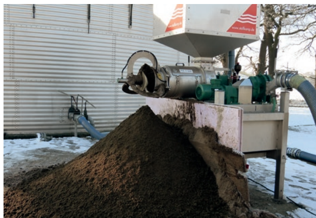
Le PSS 4-550 avec les pieds sortis en pleine séparation pour désengorger la fosse à purin. | PSS 4-550 separa con supporti prolungati e alleggerisce il magazzino fanghi.
