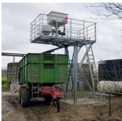
Ce PSS 2.2-400 avec récipient de collecte est installé dans un élevage porcin avec env. 5 % de matière sèche dans le lisier brut. La benne basculante est remplie en env. 1,5 jour.
